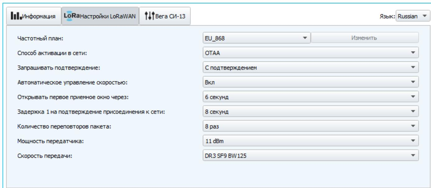
**Частотный план** – позволяет выбрать RU-868, EU-868 или задать *произвольный* частотный план.
