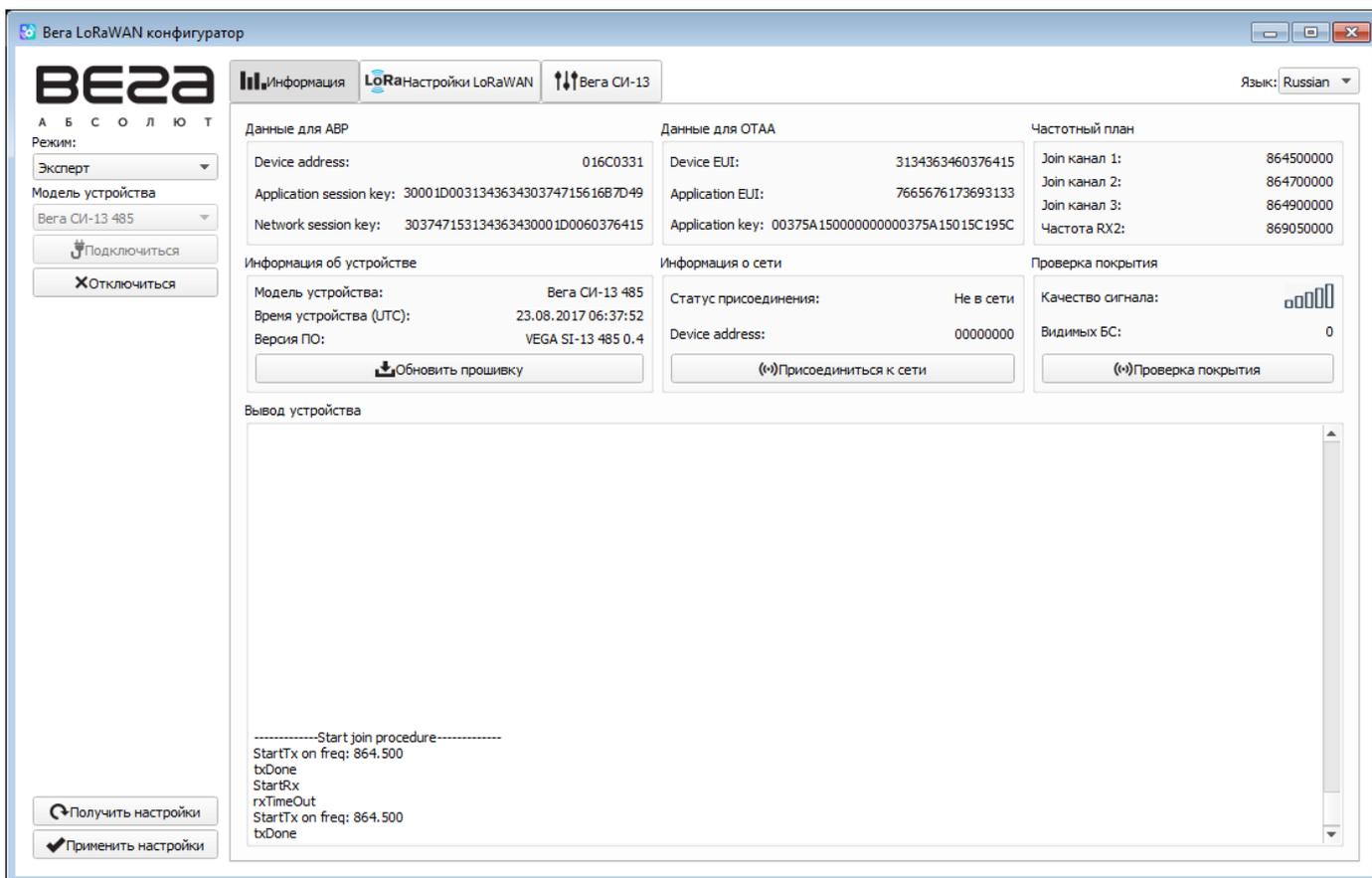
Для считывания настроек с устройства нужно нажать кнопку «Получить настройки», до этого момента в программе будут отображаться настройки по умолчанию или с последнего подключенного устройства.
